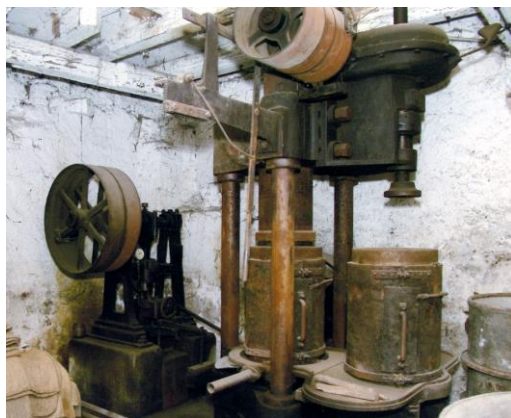
Hydraulik-Unterkolbenpresse der Fa. M.Erhard. Es wird mit zwei Pressbehältern im sog. Tandem-Verfahren gearbeitet.
